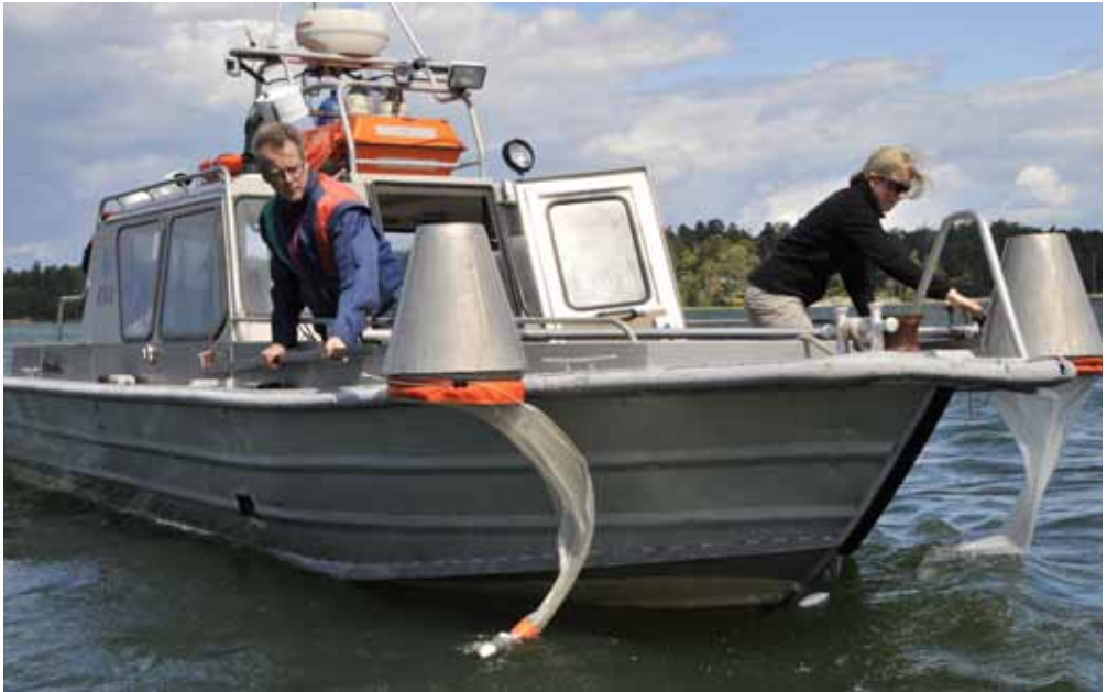
Kuva 5. Gulf Olympia -pyydykset veneen sivuilla nostettuina ylös vedestä. Kuva: Taija Pöntinen.
